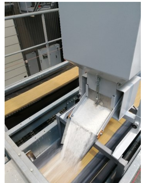
Figure 3 : Traitement du blé tendre sur le circuit de manutention de la plateforme d'Arvalis avec SilicoSec®, à l'aide d'une trémie vibrante (matériel Andermatt)
