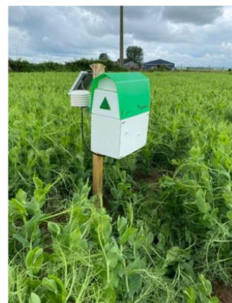
**Piège à tordeuse automatisé
