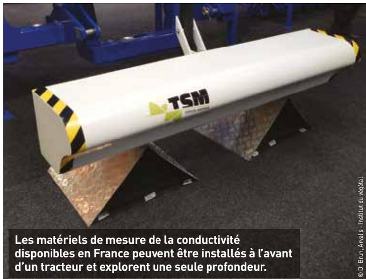
Les matériels de mesure de la conductivité disponibles en France peuvent être installés à l'avant d'un tracteur et explorent une seule profondeur.
