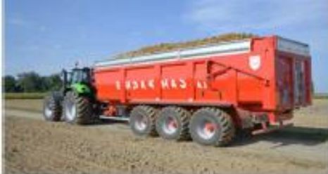
Benne: 5 passages de roue à 9 t/essieu
