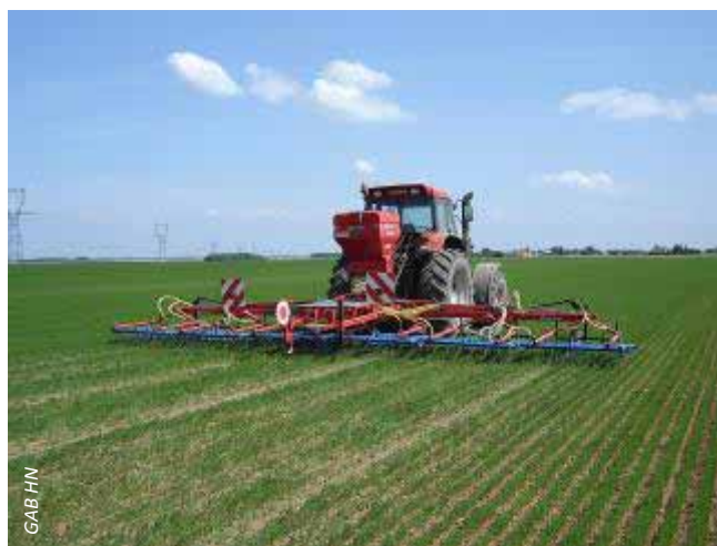
Herse étrille associée au semoir dans le lin
