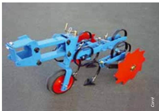
Détail d'un élément bineur à 5 pièces travaillantes
