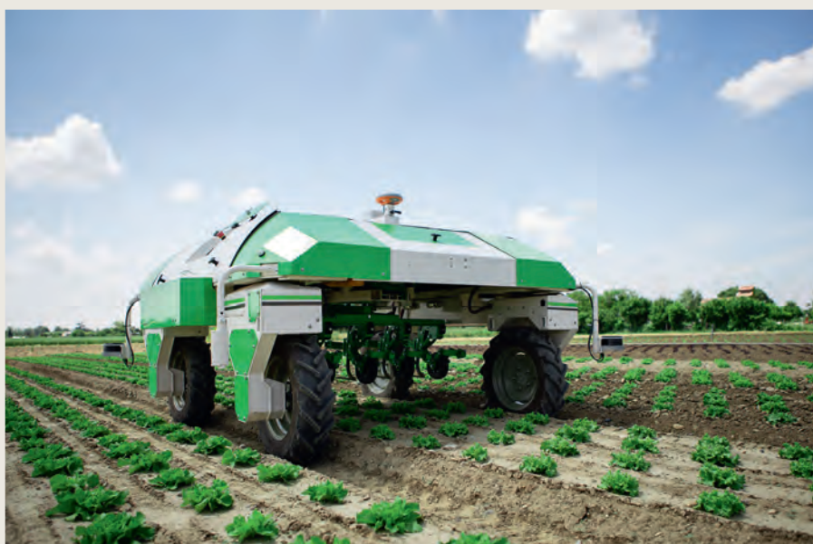
Quand l'agronomie, le numérique et la robotique se rencontrent. Le robot Dino de Naïo Technologies, ici au travail sur salade, a fait l'objet de premiers tests pour biner le blé sur la Digifermes ® de Lorraine.
