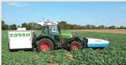
Peut-être une des alternatives au glyphosate ? L'Electroherb de Zasso est en cours de test sur la Digifirme ® d'Arvalis à Saint-Hillaire-en-Woëvre en Lorraine.
