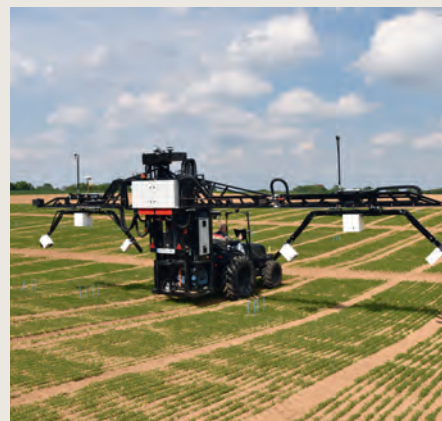
Pour la première année, l'outil de phénotypage Alphi a évolué sur des cultures de lin fibre. Il va permettre de connaître plus finement le fonctionnement des cultures et aidera physiologistes et sélectionneurs.
