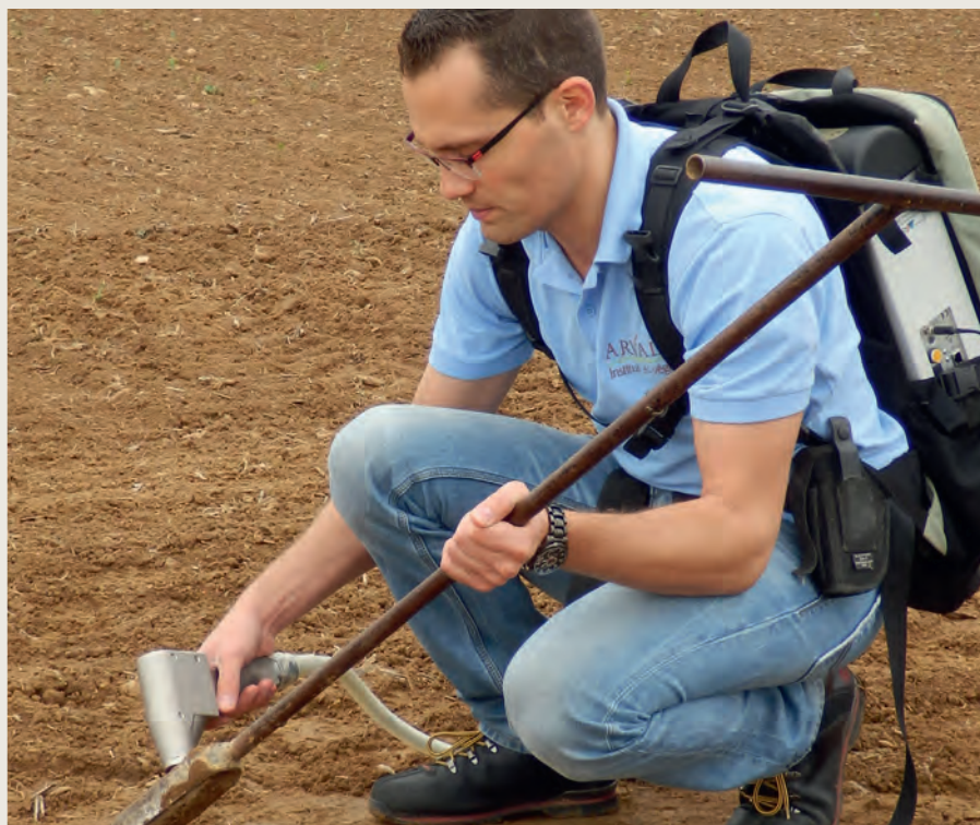
Arvalis a mis au point, avec Auréa AgroSciences, un laboratoire portatif d'analyse de terre et le service Spirit Sol+ pour suivre la fertilité du sol. Capable de scanner des échantillons de terre et d'en analyser la composition en quelques secondes, cet outil utilisable au champ fera gagner beaucoup de temps et de précision aux agriculteurs.
