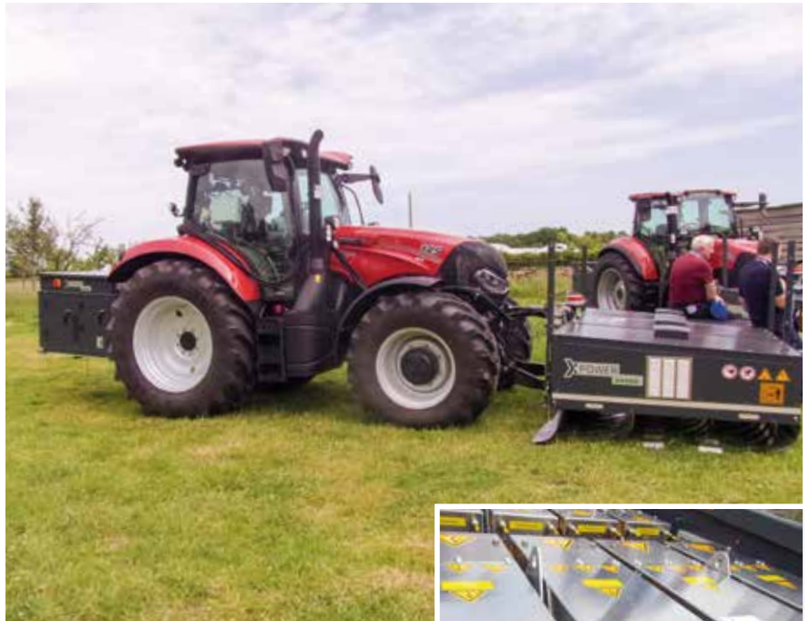
> La nouvelle configuration de Xpower positionne les modules de conversion de courant sur la partie avant du matériel
