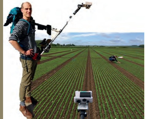
La perche LITERAL , équipée de 3 caméras à haute résolution, permet d'automatiser le comptage numérique du nombre de plantes/m 2 de parcelles expérimentales : un exemple ici pour le lin fibre.
