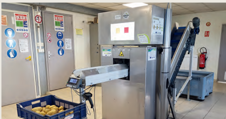
Arvacefp , fruit d'une collaboration de 2 ans entre ARVALIS et Eurocefp, permet la quantification numérisée du taux de germination des lots de pomme de terre expérimentés. Une solution d'une très grande utilité pour pouvoir gérer les 130 000 tubercules à analyser dans le cadre des essais mis en place suite à la suppression du CIPC.
