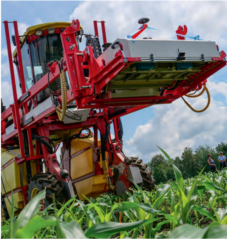
Phe-B appartient à la famille des systèmes embarqués complets pour le phénotypage haut débit comme la Phénomobile ou ALPHI . La particularité de Phe-B est d'être montée sur un enjambeur classique, matériel répandu, ce qui la rend plus accessible pour la recherche publique et privée.
